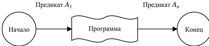
Рис. 3.6 — Определение входа и выхода программы с помощью предикатов  $A_1$  и  $A_n$
